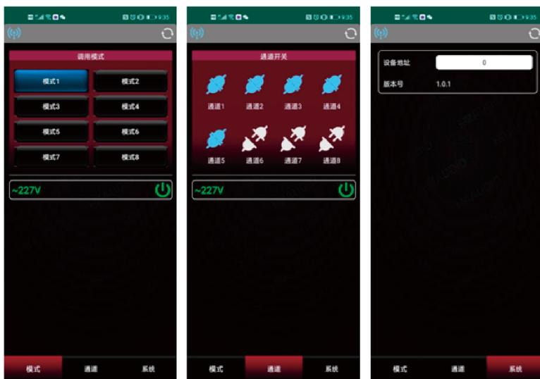
3) 控制界面分3个界面：模式、通道、系统；可在快速开机框中，看到当前设备的电压值、和开关机状态，并控制开关机状态；模式：8组模式快速调用；通道：8组通道开通和关闭；系统：配置设备地址ID。
