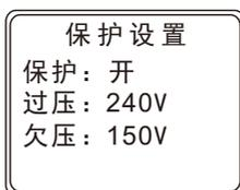
在保护设置页面下，第一项设置保护功能的打开或关闭然后设置起控点电压。保护选项中分别设有：开、关、自动；自动与开的最大区别在于，当选中自动时，当通道断开后电压回复到设定后，通道会自动恢复，反之设定开的话通道不会自动恢复，通道将一直全部关断，需手动恢复。
