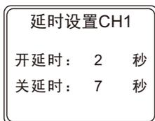
在延时设置页面下，可分别设置各通道的开通时间和关闭时间。可设置范围均为0-999s，∞。当开延时选项设成无穷大，即表示此通道永远不会接通，当关延时选项设成无穷大，即表示此通道永远不会关闭。
