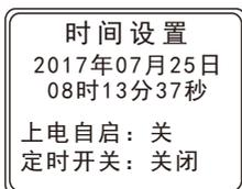
在时间设置页面下，可以校对机器当前的实际年月日时间。这一页面同时也设有“上电自启”和“定时开关”两个选项。定时开关中设有3种状态：关闭、循环、非循环。循环：设定每天固定时间打开；非循环：特定时间打开。上电自启即当机器接通电源，自动启动预设好的通道。
