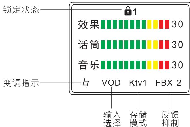
开机界面显示本机基本参数和状态，画面清晰简洁，调试方便。此界面下转动EFF VOL, MIC VOL, MUSIC VOL旋钮，可调节机器的效果、话筒、音乐音量。面板上下方向键可快速调试变调功能，左右方向键可快速调试反馈抑制。
