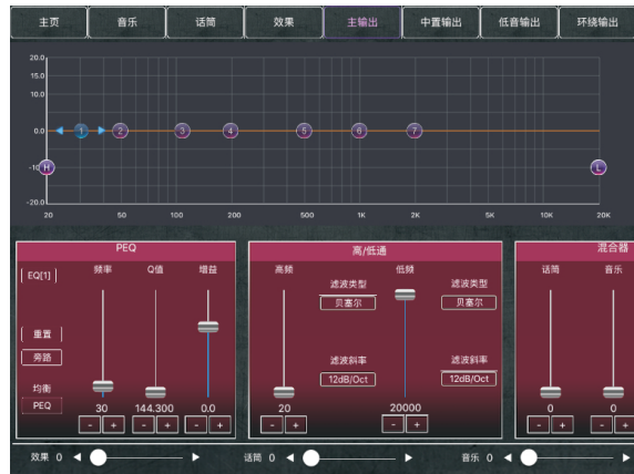
主输出 混合+高低通+7段均衡+增益延时+限幅
